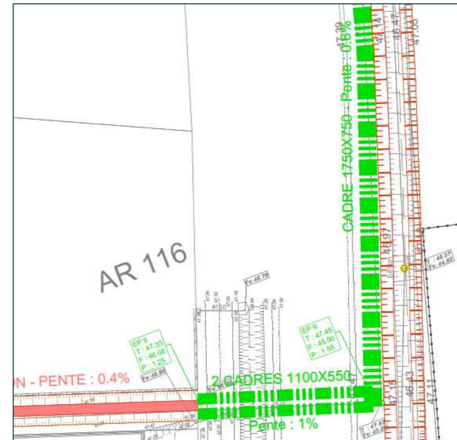
Figure 10 : Extrait de la proposition d'aménagement faite lors du schéma hydraulique pluvial de la RM5 permettant de relier le futur lotissement au bassin de rétention nord du complexe sportif
