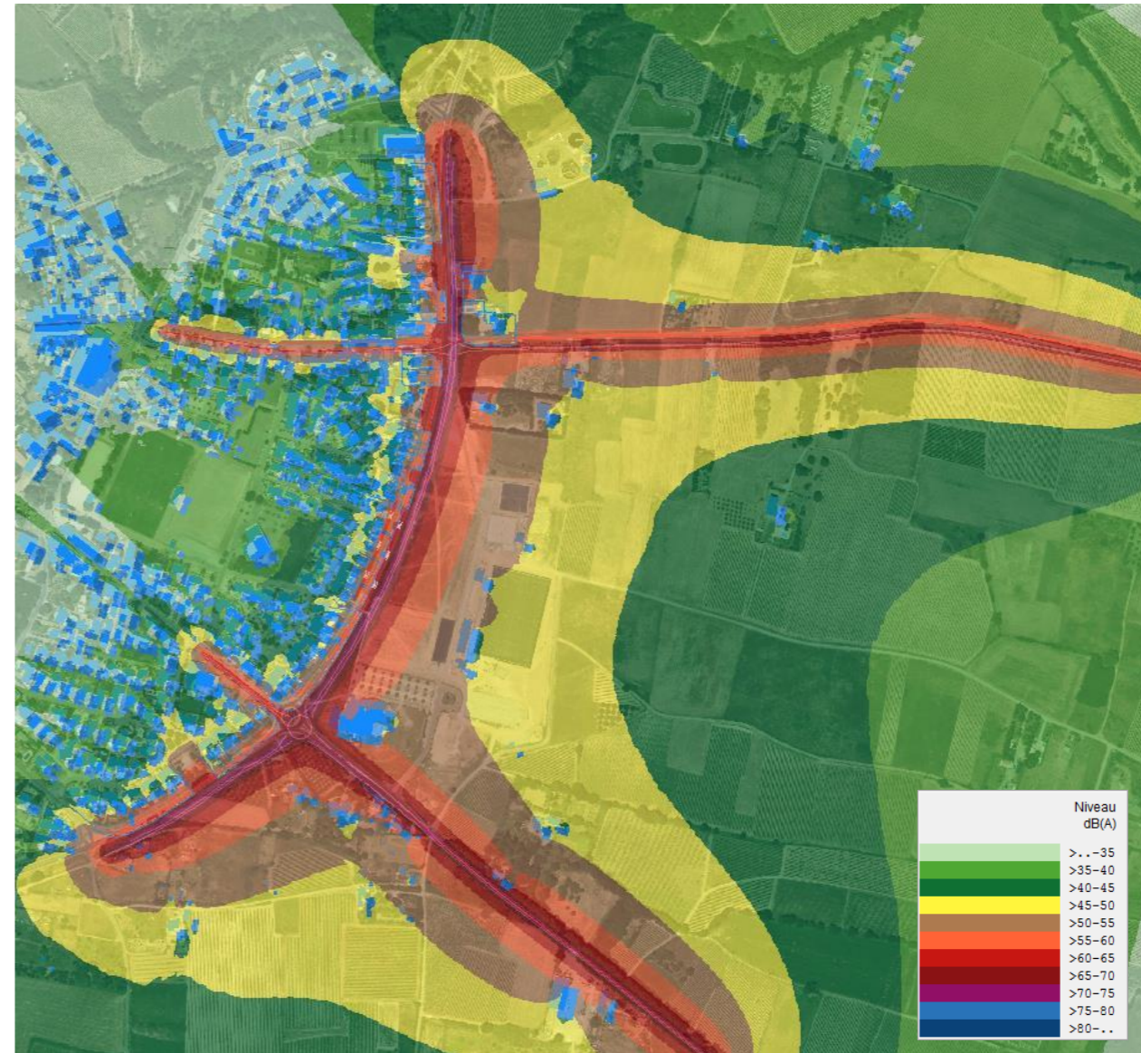
Figure 38 : Cartographie de l'état sonore initial en période diurne à l'horizon 2023 à 1,5m de hauteur, A2MS 2021
