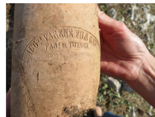
Fig.72. Tuyau en grès avec estampille. Cl. L. Caliste, J. Desagher, 2021
