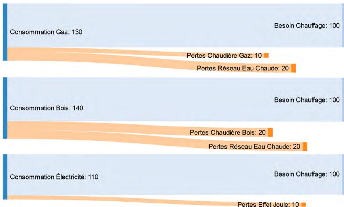
Figure 8: Schéma simplifié de la chaîne énergétique de plusieurs systèmes de chauffage
