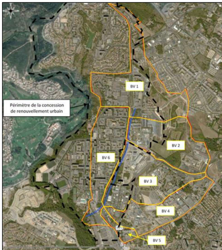
Sous-bassins versants du Rieutord et emprise du secteur d'étude Extrait du rapport référence UFRN116RIV, Egis, juin 2021
