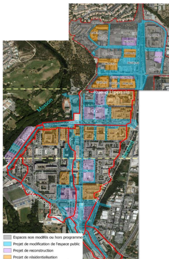
Répartition des différents types d'espaces sur les quartiers Saint-Paul, Halles et Mosson Sud Extrait présentation Quartier de la Mosson gestion des eaux pluviales 23/03/2022, Egis
