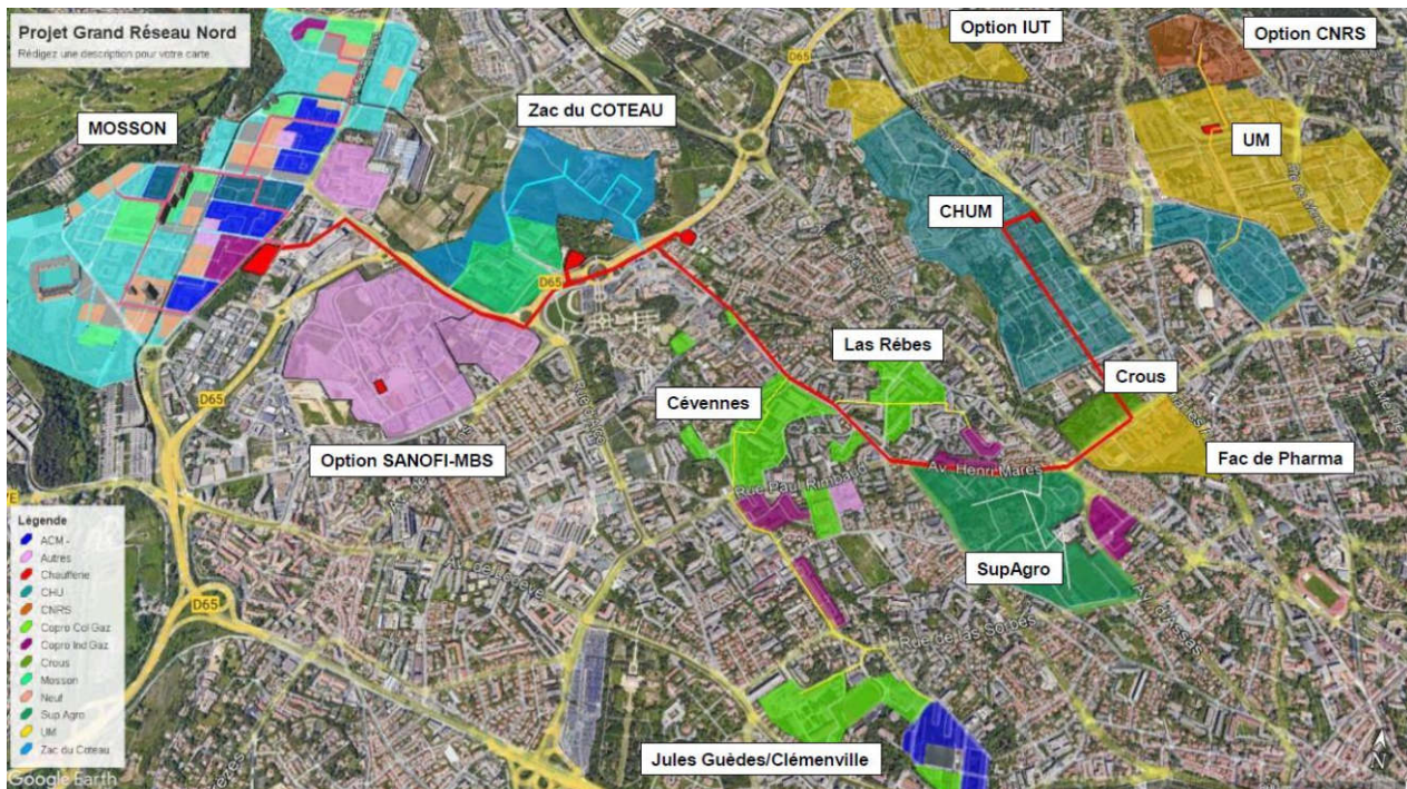
En rouge, tracé du réseau de chaleur urbain nord de Montpellier avec positionnement des chaufferies.
