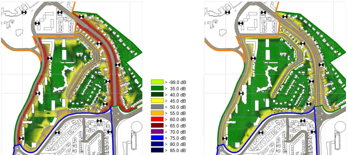
Cartes des isophones à 2m de hauteur pour la zone 3 à l'état initial, de jour et de nuit, Étude acoustique, Bet PIALOT-ESCANDE, Septembre 2022.
