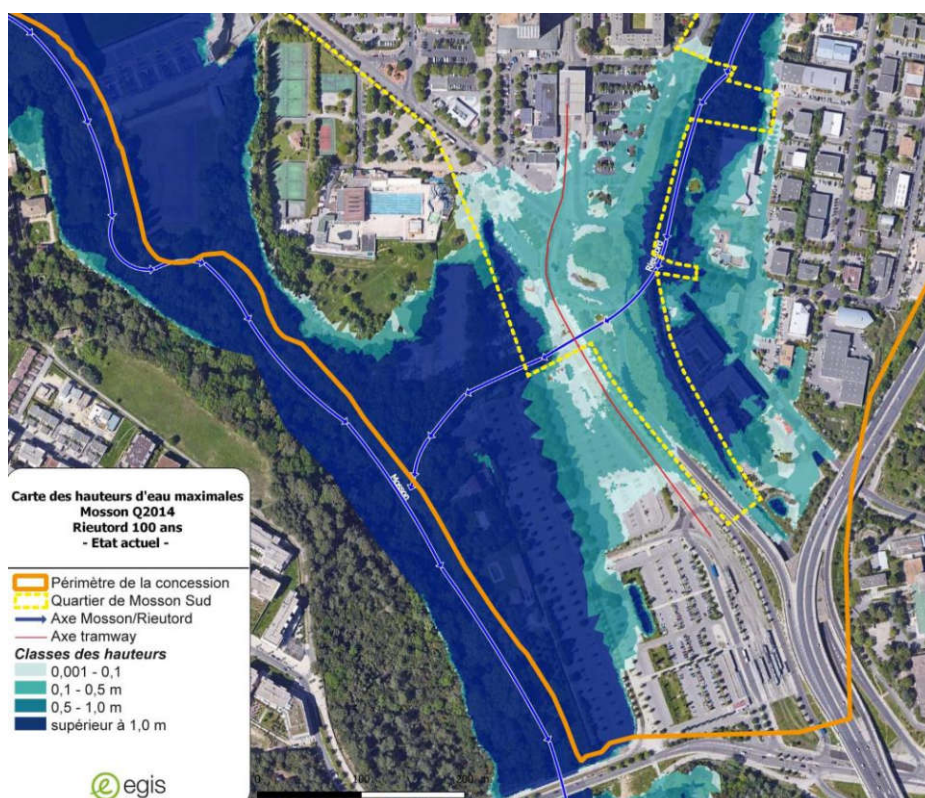
Carte des zones inondables et hauteurs d'eau – Crue de type 2014 Mosson et Crue 100 ans Rieutord Extrait rapport référence URNF116RIV_V2, Egis, Juin 2021
