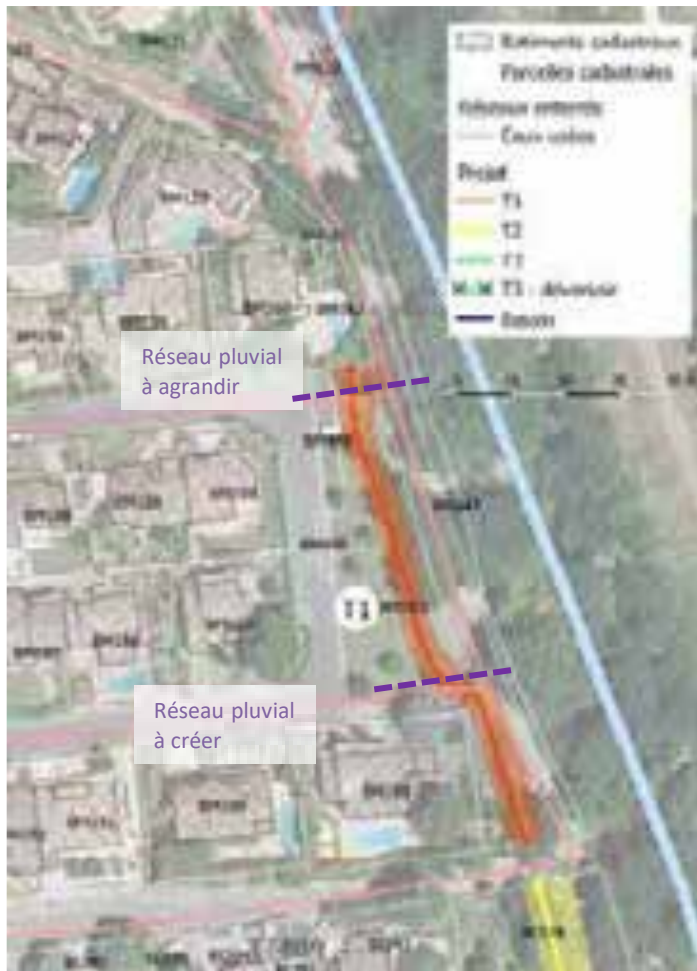
Figure 27 : Réseaux présents sur le tronçon T1
