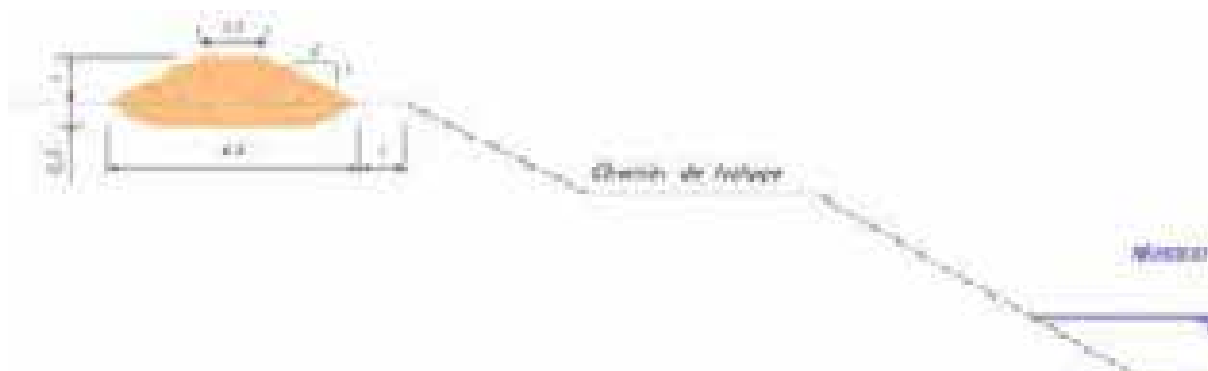
Figure 6 : Profil en travers de la digue sur T1 (hors secteur en enrochement)
