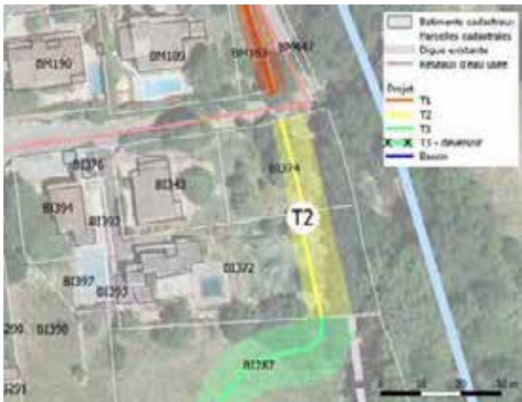
Figure 28 : Tracé de la digue sur le tronçon T2
