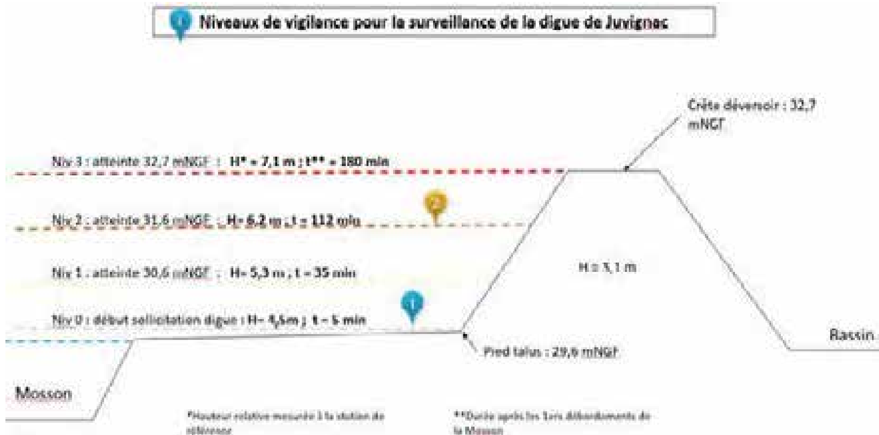
Figure 17 : Niveaux de surveillance du système d'endiguement de la Mosson
