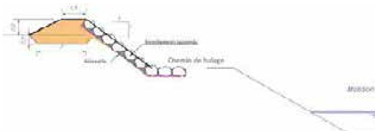
Figure 7 : Profil en travers de la digue sur T1 dans sa partie en enrochement côté Mosson
