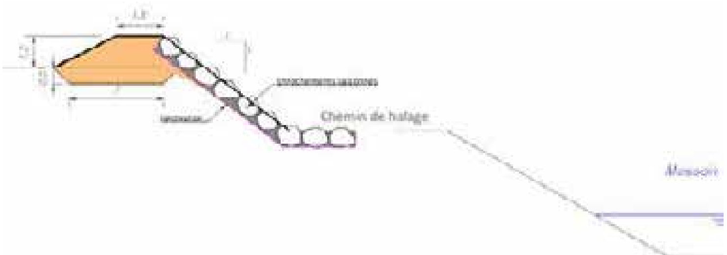
Figure 26 : Coupe type de la digue au droit de l'aval du tronçon T1, nécessitant des adaptations
