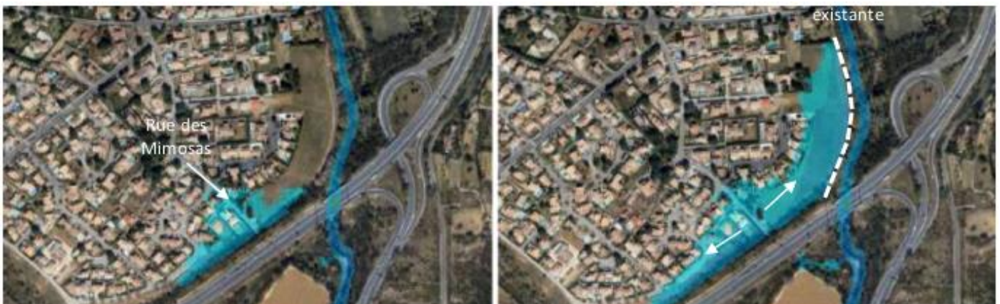
Figure 59 : Inondation par le ruisseau de la Plaine (Source : Egis Eau – 2015)
