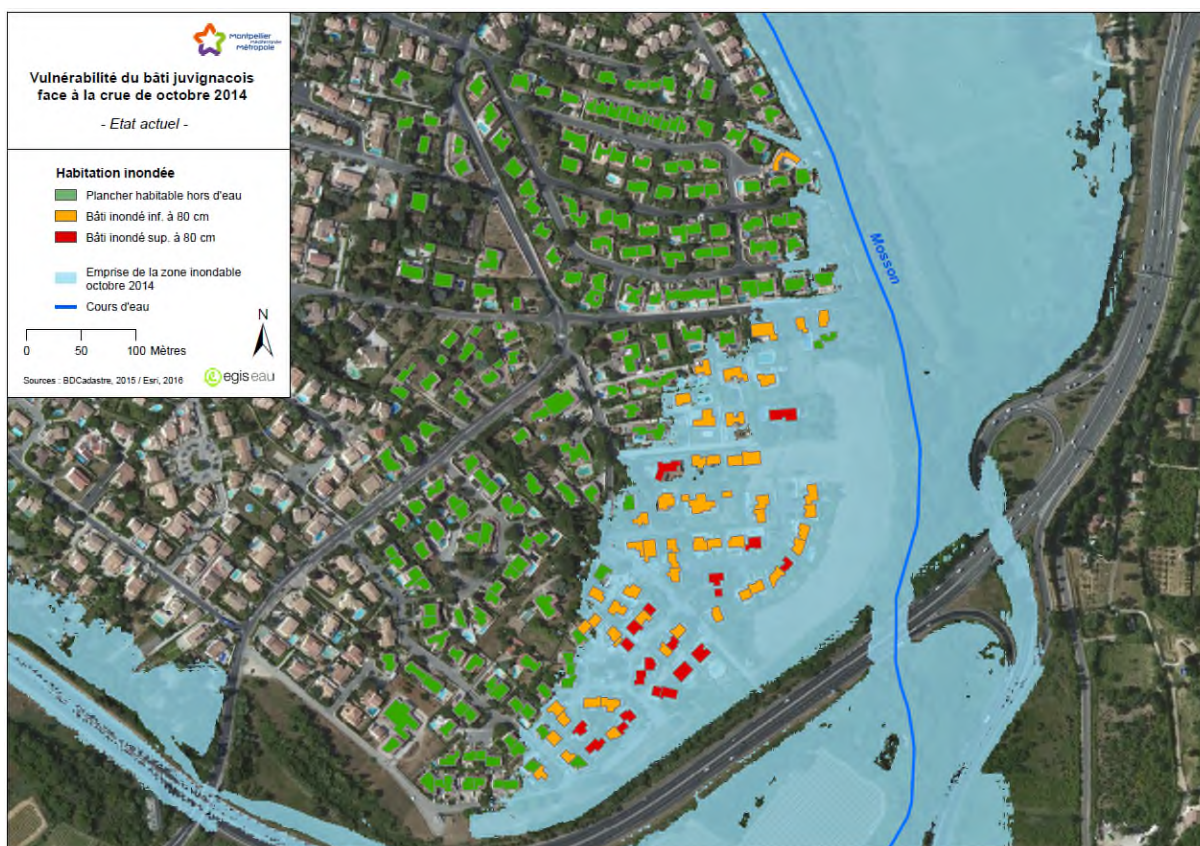
FIGURE 5 : EMPRISE DE LA ZONE INONDABLE LORS DE LA CRUE D'OCTOBRE 2014 ET MAISONS INONDÉES
