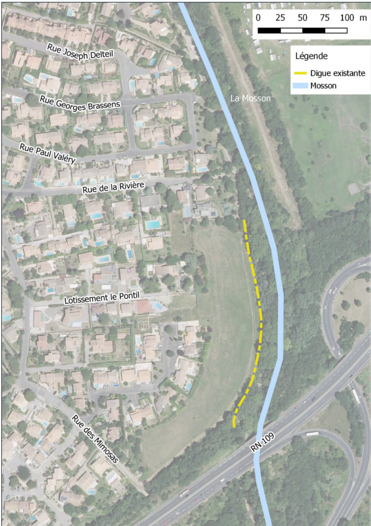
FIGURE 5 : QUARTIER DE LA PLAINE ET OUVRAGE EXISTANT (DIGUE)
