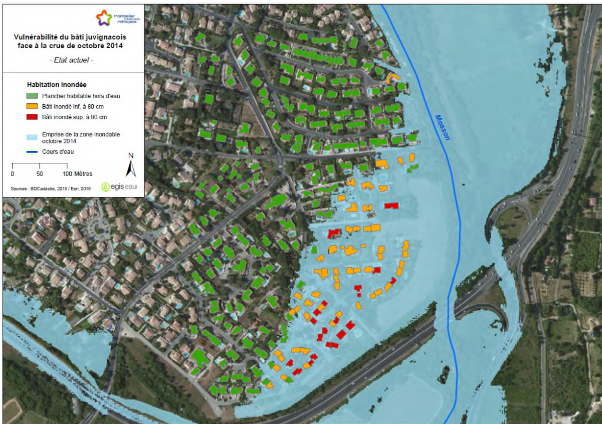
FIGURE 2 : EMPRISE DE LA ZONE INONDABLE LORS DE LA CRUE D'OCTOBRE 2014 ET MAISONS INONDÉES
