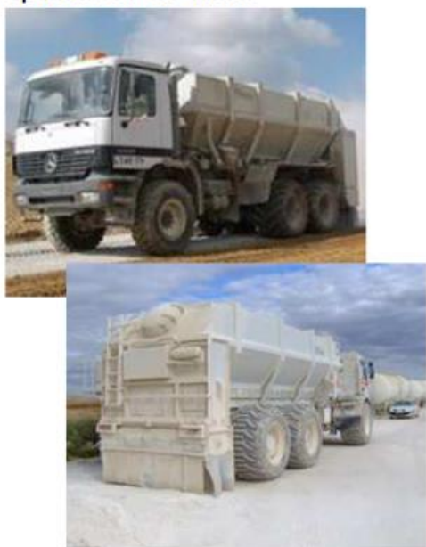
Épandeur de liant
