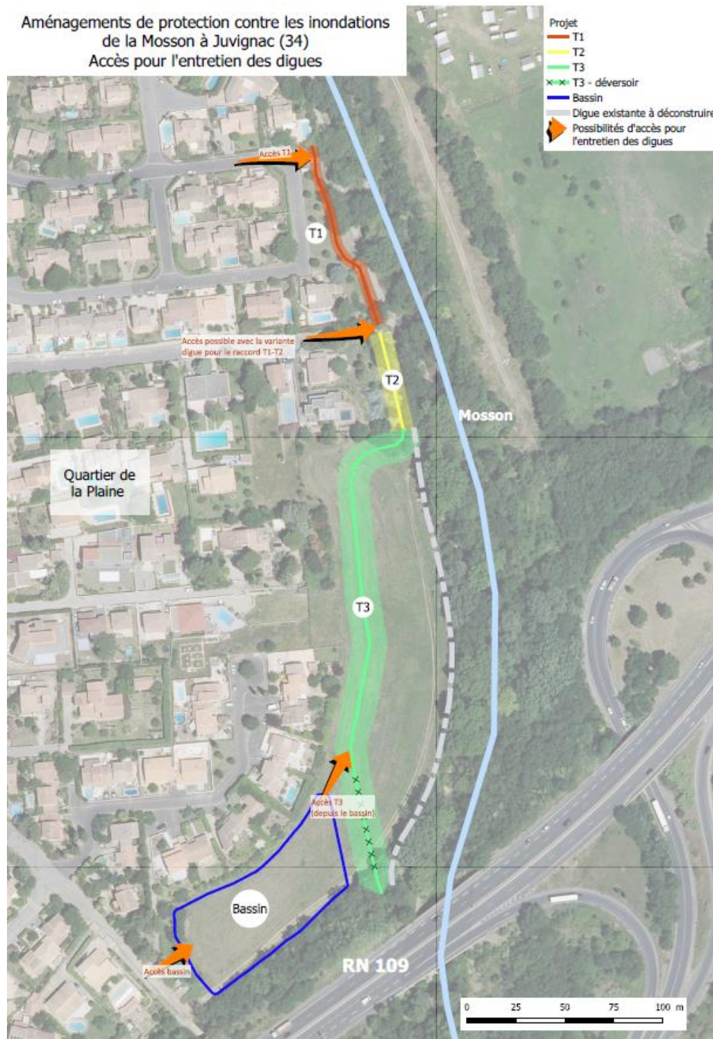
Figure 24 : Accès pour l'entretien des digues
